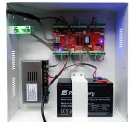
Los Gabinetes IN-Box vienen con las perforaciones para la instalación de las placas electrónicas, fuente, etc. También tienen ranuras y accesos pre cortados para el paso de los caños.
